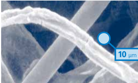
従来のフィルターろ材 (電子顕微鏡 600x)
